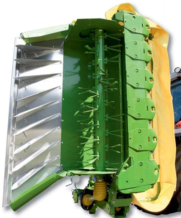
**Acondicionamiento de ancho completo:** con mayales de acero en V, chapa acanalada, cubierta de aluminio y chapas directrices opcionales, la acondicionadora abarca todo el ancho de trabajo de la máquina. Este diseño permite un transporte y distribución uniformes de la materia vegetal.
